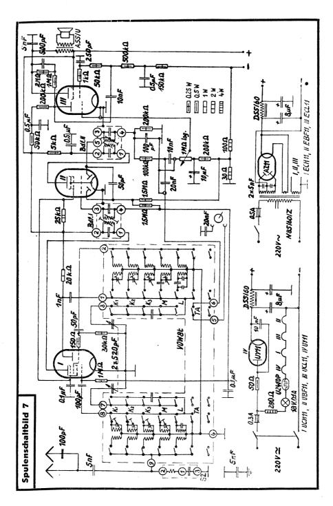
Bei der Berechnung aller Spulen- und Kapazitätswerte wurde der sogenannte Normdrehko zugrunde gelegt, der ein Anfangs-C von 11 pF und ein End-C von 533 pF hat. Die Abweichung der Vorkreis- von den Oscillatorkapazitätswerten soll in allen Drehwinkelstellungen möglichst geringfügig (unter 1%) sein und jeder Drehko, der diesen Forderungen entspricht, kann, ohne daß die angegebenen Wellenbereiche sich ändern, Verwendung finden.
