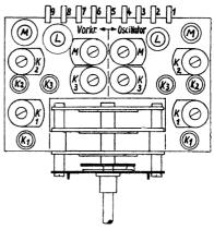
Einbau: Das Aggregat VOW-8t wird mittels Einlochmonlage und Verdrehungsschutz im Chassis montiert." Die Achse ist so lang (68 mm) gehalten, daß auch der Drehko mittels Hohlachse von dort aus angetrieben werden kann. Die Einbautiefe ist 100 mm einschließlich Lötösen. Die Anschlüsse an der rückwärtigen Lötösenleiste sind folgende:
